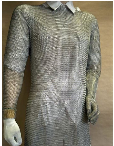
Abb. 18 Stechschutzhemd mit Metallringgeflechtshandschuh mit Stulpe (linke Hand) und Schnittschutzhandschuh (rechte Hand)
