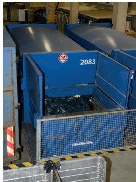
Sammlung im Presscontainer auf dem Entsorgungshof
