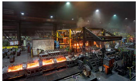
Abbildung 6: Herstellung von Metallrohren in einem Stahl- und Walzwerk
