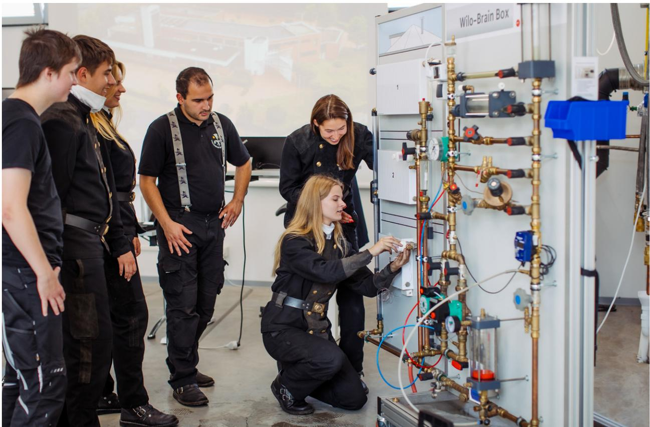
Abbildung 16: Versuche an einer Hydraulikwand (Quelle: Bundesverband des Schornsteinfegerhandwerks)
