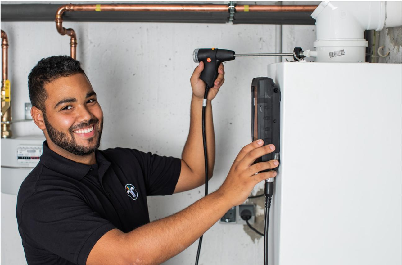
Abbildung 6: Immissionsschutzmessung an einer Gasfeuerstätte (Quelle: Bundesverband des Schornsteinfegerhandwerks)
