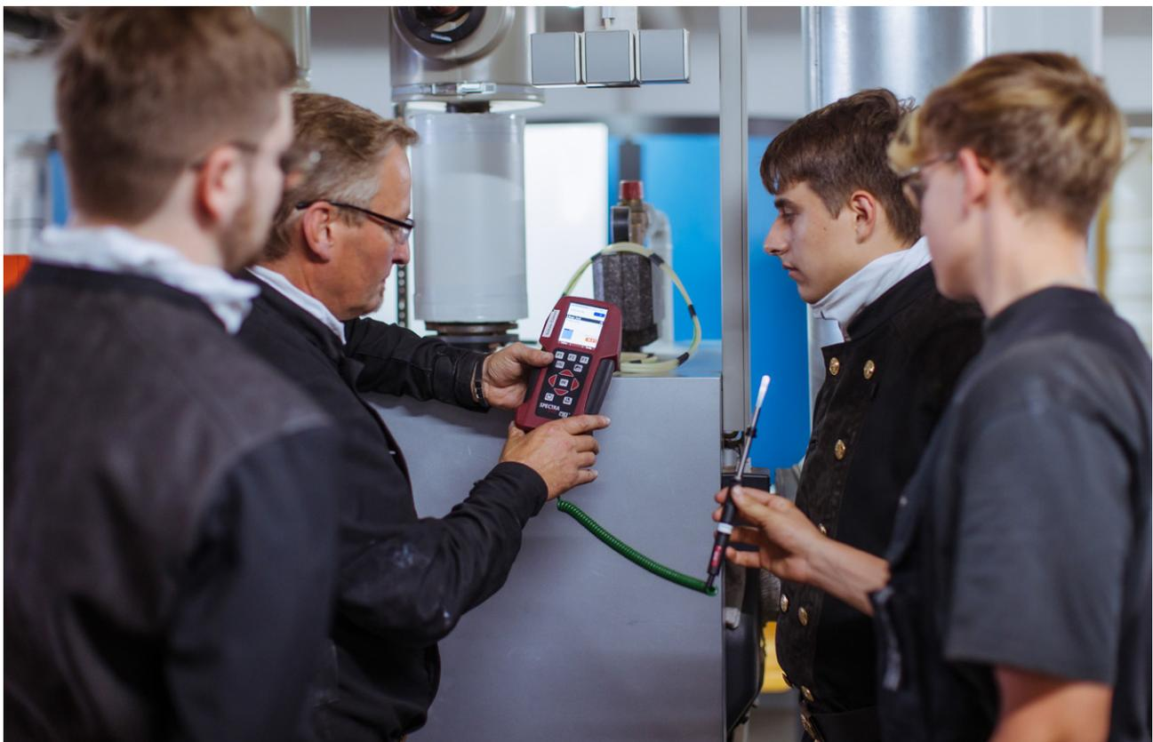
Abbildung 10: Einsatz eines Messgeräts zur Analyse von Abgaswerten an einer Heizungsanlage (Quelle: Bundesverband des Schornsteinfegerhandwerks)
