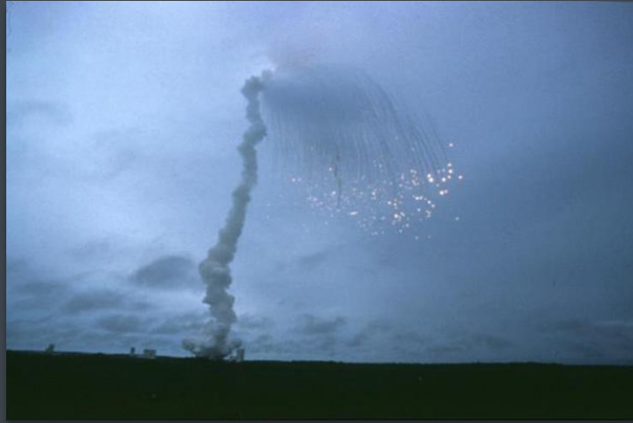
Explosion des ersten Ariane 5 Flugs aufgrund eines Softwarefehlers
