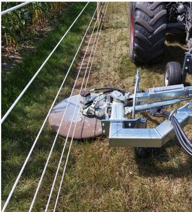
Freischneidetechnik an einer Zugmaschine unter einem wolfsabweisenden Pferdezaun. Dies wäre auch für Rinder und Schafe/Ziegen geeignet.
